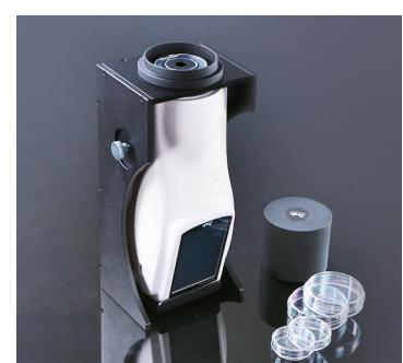
Среди дополнительных аксессуаров в серии NS предусмотрена универсальная конструкция, помогающая измерять жидкие, порошковые или пастообразные образцы, её габариты: 110\*85\*300 мм (д., ш., в.).
